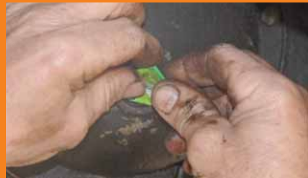
Do przekładni głównej dodaliśmy rewitalizant przekładniowy
