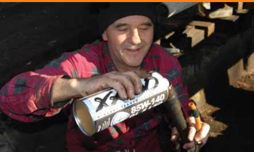
Tak jak do mostu tak i do skrzyni biegów olej wlewaliśmy za pomocą pompy
