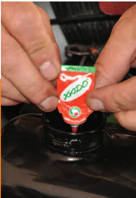
Po wkręceniu świec i ponownym rozgrzaniu dozujemy preparat XADO do silnika.
